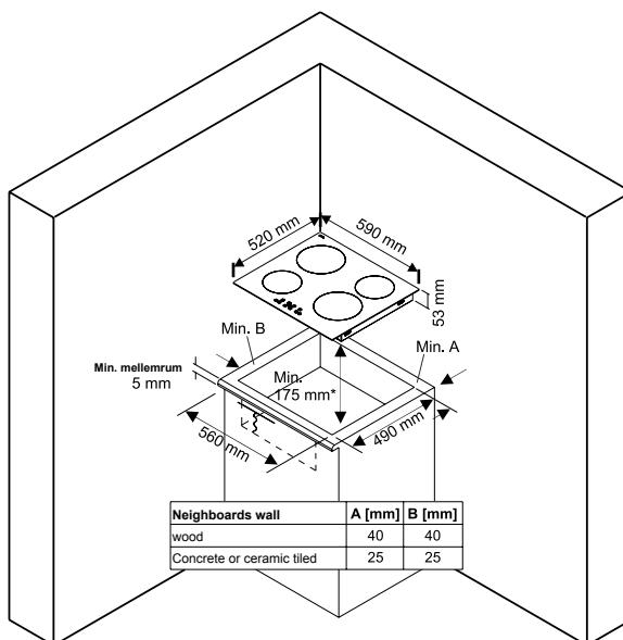
\* In geval van een installatie boven een ingebouwde oven moet de afstand min. 10 mm. zijn.
