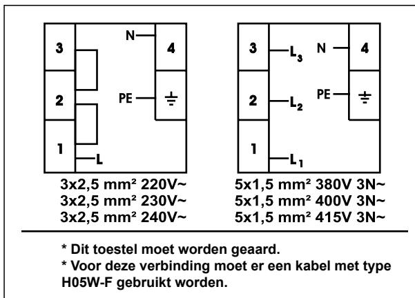
Voor de inductiekookplaat moet de kabel H05VV-F 3X2,5 mm<sup>2</sup>/60227 IEC 53 • zijn. Op de onderzijde van uw apparaat vindt u het bedradingsschema.
