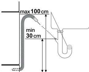
Der Ablauchschlauch kann nach rechts oder links verlegt werden
