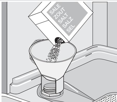
4. Die Verschlusskappe wieder anbringen und sicherstellen, dass kein Salz auf dem Gewinde oder der Dichtung vorhanden ist.
