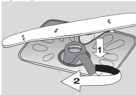
**i** N'utilisez jamais le lave-vaisselle sans les filtres. Si les filtres n'ont pas été correctement réinstallés, les performances de lavage pourront être compromises et l'appareil pourrait être endommagé.
